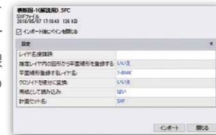
SXF ファイルインポート時の設定 レイヤー名を指定しながら線形クロソイドデータの登録を行う
