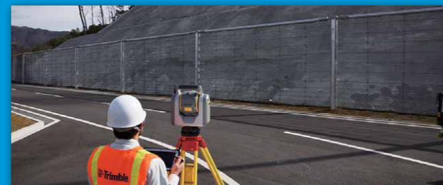
SX12 は後視、基準点の位置を測角精度 1"、測距精度 1mm でかつ、1 点で視準をします。3D スキャナーで多く使用されるターゲットとは異なり、プリズム等の対象物を 1 点で視準することから、極めて高い観測精度と成果を得る事が可能です。
