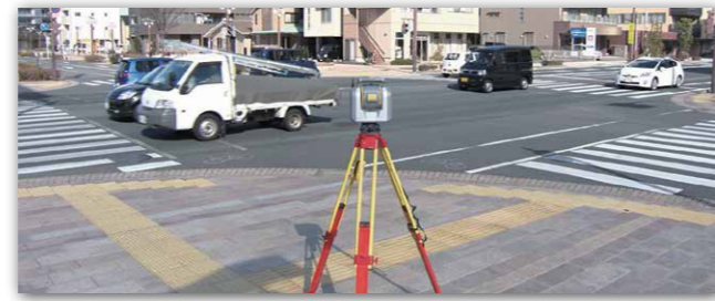
多くの車が行きかう交差点で点群計測
